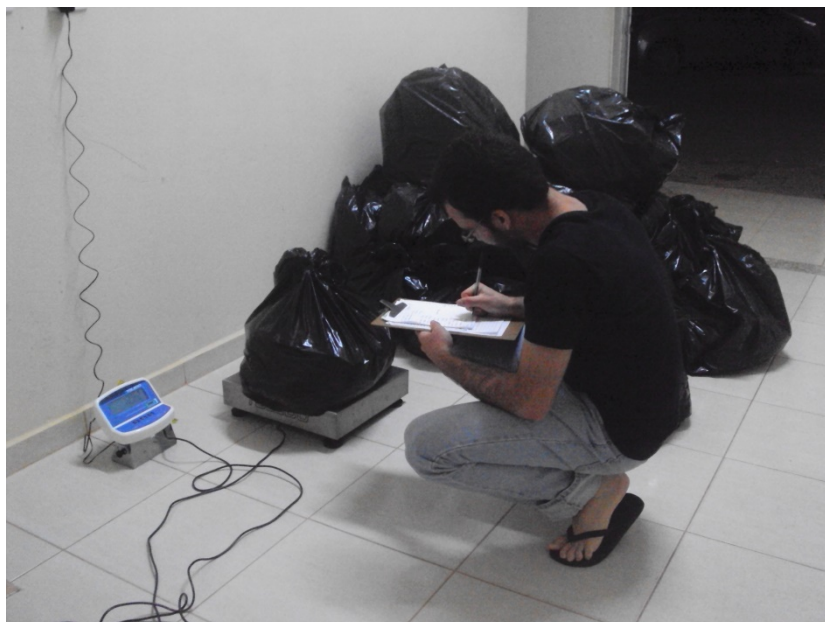
Figura 4 – pesagem dos sacos com os materiais separados. Fonte: arquivo pessoal do autor, 2013.
